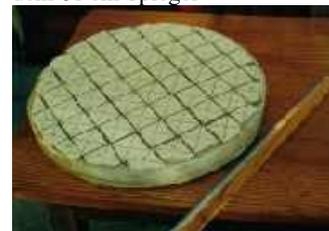
Bild 2: Das mit Fliesen beklebte Schleifwerkzeug
