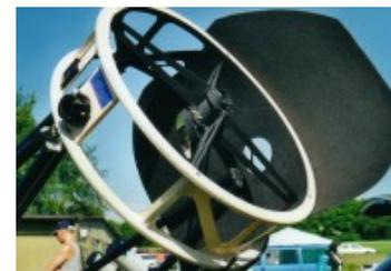
Bild 7: Der "Hut" mit exzentrischer Spinne und Streulichtblenden
