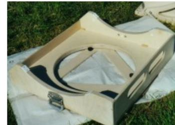
Bild 9: Innen offene Wiege in Sandwichplatten Bauweise
