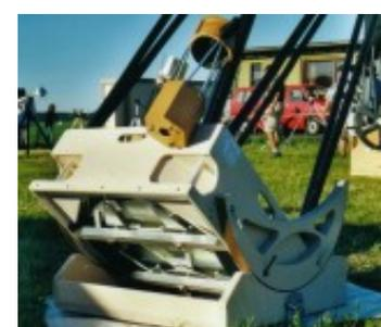
Bild 8: Spiegelbox mit 27 Punkt Zelle und abnehmbaren Höhenlagern
