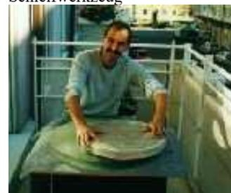
Bild 3: Schleifen der einzelnen Körnungen mit Methode "Tool on Top" (Schleifwerkzeug oben)
